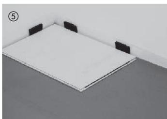
Начиная с левого угла комнаты, элементы укладываются гребнем к стене и фиксируются распорными клиньями или дистанционной прокладкой (расстояние до стены для компенсации расширения 10 - 15 мм).
